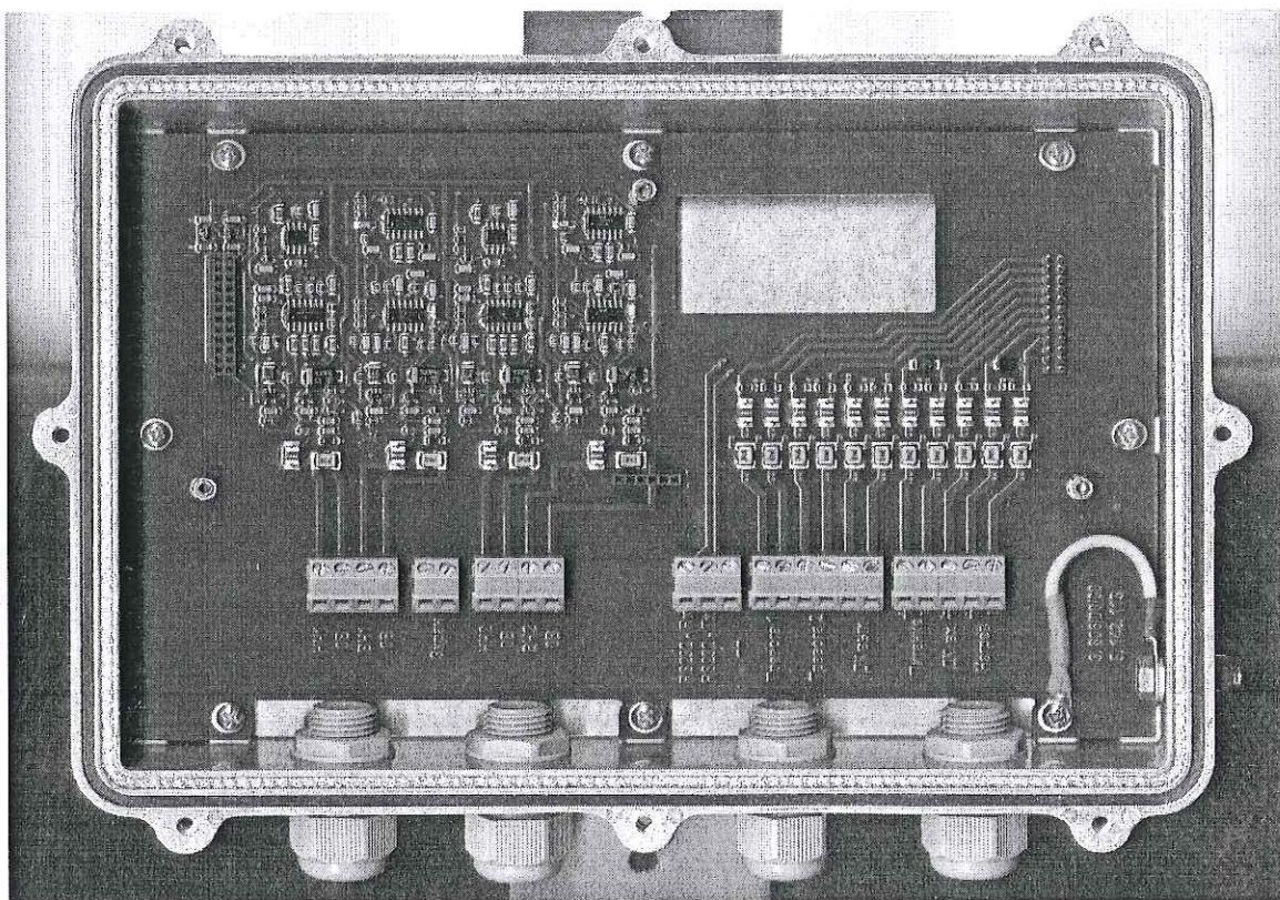
Рисунок 3 – Плата усилителя в корпусе
