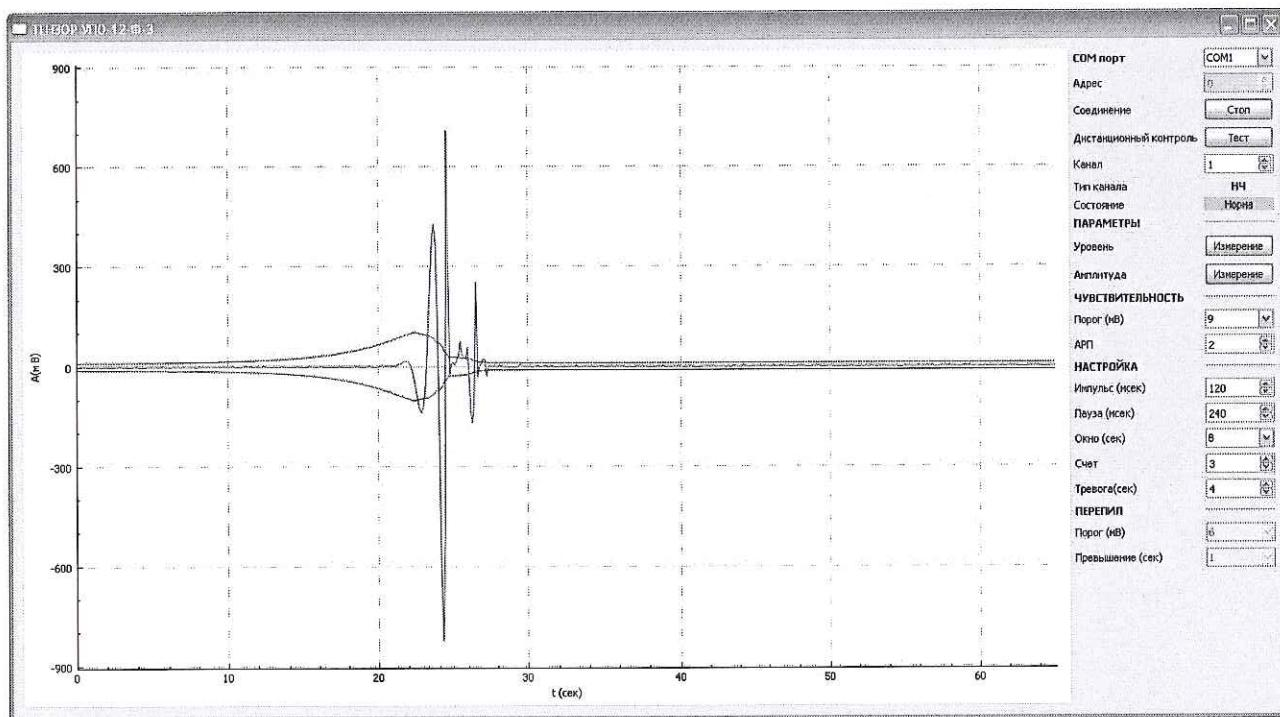
Кнопка «Канал» предназначена для переключения каналов. На кнопке отображается номер канала, параметры которого отображаются в настоящий момент на экране.
