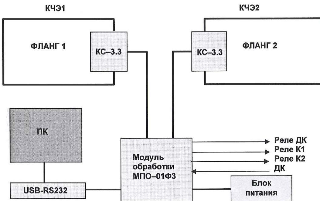
Рисунок 5 – Структурная схема УПО
