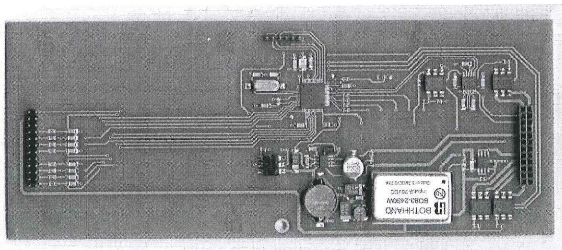
Рисунок 4 – Плата процессора
