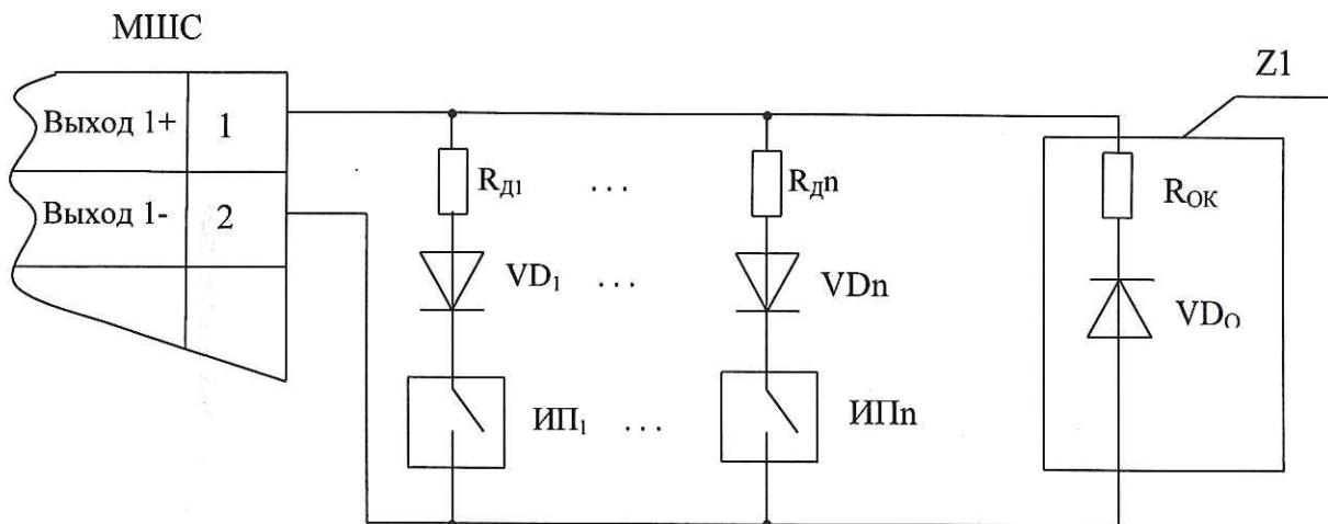
$R_{d1} \dots R_{dn}$  – добавочное сопротивление С2-33Н-0,5-470 Ом $\pm 5\%$  (может отсутствовать),
