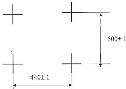
Рисунок 2.1 - Разметка для крепления прибора
