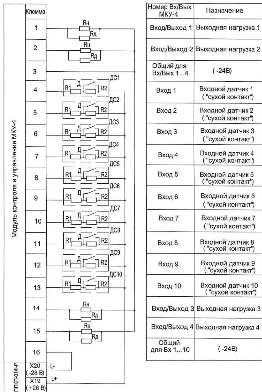
Резисторы R1 и R2 устанавливаются в конце линии непосредственно у датчика Д.
