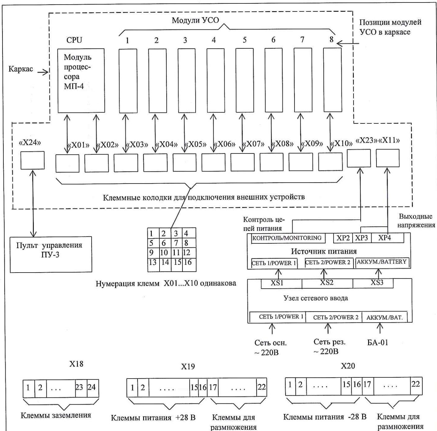
1 В различных вариантах исполнения прибора устанавливается различное количество модулей УСО и соответствующих клеммных колодок. Позиции модуля процессора и модулей УСО строго определены для каждого варианта исполнения.
