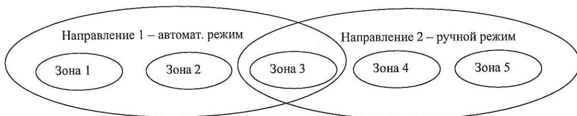
При обнаружении пожара в «Зона 3» в «Направление 1» начинает выполняться алгоритм пуска. В «Направление 2» устанавливается состояние зоны «Зона 3» и алгоритм пуска не выполняется.
