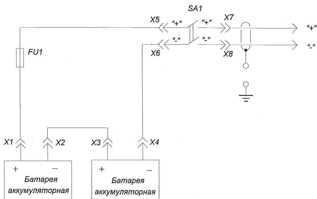
Рисунок Б.2 – Схема блока аккумуляторов BA-01
