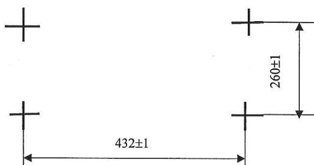
Рисунок 2.2 - Разметка для крепления блока аккумуляторов БА-01
